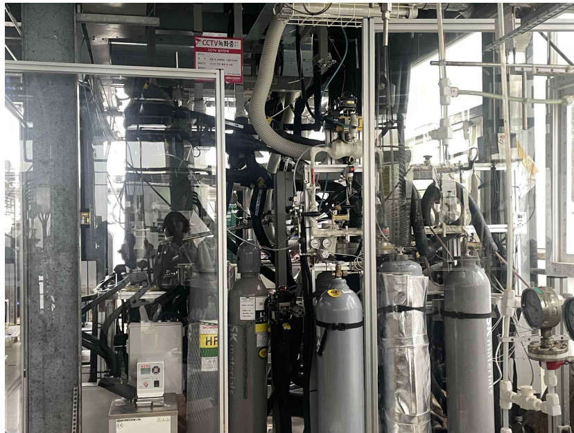
▲과불화화합물 생산에 필요한 CH→CF 치환이 이루어지는 실험 설비
